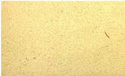
ภาพที่ 2 กระดาษจากฟางข้าวผสมแป้งในขั้นตอนการปั่นเยื่อน้ำหนัก 50 กรัมของน้ำหนักเยื่อเปียก
