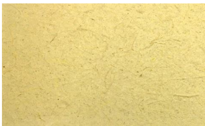
ภาพที่ 4 กระดาษจากฟางข้าวผสมแป้งในขั้นตอนการปั่นเยื่อน้ำหนัก 70 กรัมของน้ำหนักเยื่อเปียก
