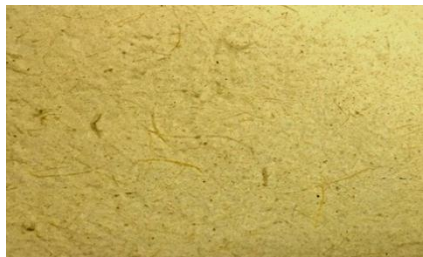
ภาพที่ 3 กระดาษจากฟางข้าวผสมแป้งในขั้นตอนการปั่นเยื่อน้ำหนัก 60 กรัมของน้ำหนักเยื่อเปียก
