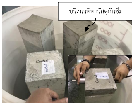
รูปที่ 3 แท่งคอนกรีตที่ท้าวสตุกันซีมที่ผิวบน ในขณะที่แช่น้ำและวัดค่าความหนาแน่นด้วย UPV ที่ระยะทาง 20 เซนติเมตร
