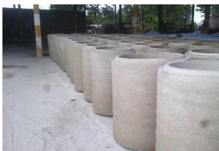
ภาพที่ 6 ผลิตภัณฑ์ท่อคอนกรีตเสริมเหล็กที่ใช้หินฝุ่น ร้อยละ 80 (S20 : DS80)
