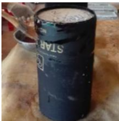
ภาพที่ 7 การเตรียมตัวอย่างที่พันผ้าเสริมกำลังเรียบร้อยแล้ว
