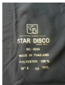
ภาพที่ 5 ผ้าโพลีเอสเตอร์ 100 % ที่นำมาทดสอบ เสริมกำลัง
