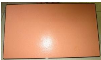
รูปที่ 5 ลักษณะฟองน้ำเมื่อเกิดการเจลในเบ้า (ขนาด 20 cm x 30 cm)
