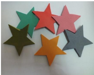
รูปที่ 7 ฟองน้ำที่เตรียมจากยางธรรมชาติชนิดที่ผสมสารตัวเติมแคลเซียมคาร์บอเนตในปริมาณ 100 phr. (ขนาด 15cm x 15cm)
